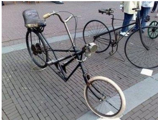
J-Ray fiets met hefboom aandrijving Ing. Jaray (1924 Duitsland)
