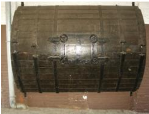
Roterende tonnen waarin de huiden na het looi- proces werden gedaan om "gaar" gemaakt te worden.
